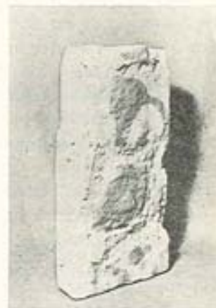
Fig. 15.03. Klinker afsprængt på grund af fugtakkumulering og frost.
