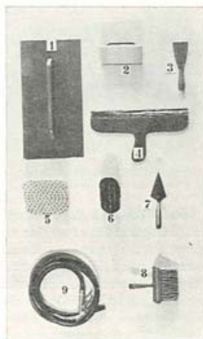
Fig. 9.03. Værktøj til slutpudsning. 1: Stålbrædt, 2: Fjlsbrædt, 3: Spartel, 4: Bred spartel, 5: Sembrædt, 6: Stålberste, 7: Beskæreske, 8: Græskost, 9: Vandslange med spreader.
