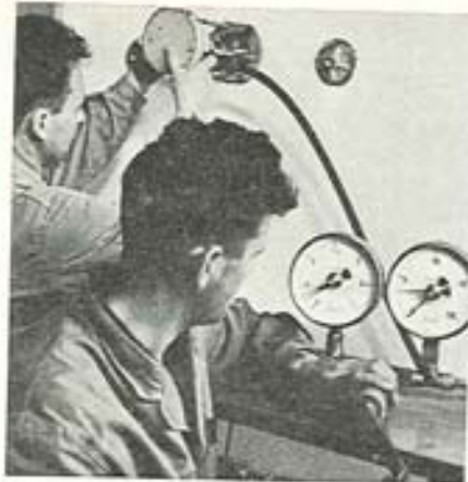
Fig. 9.40. Prøvning af pudslags vedhængning.
