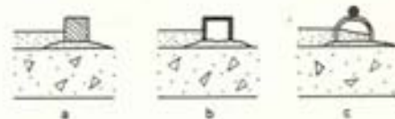
Fig. 14.03. Ledere med afrettet og derefter vibreret mørtel.
