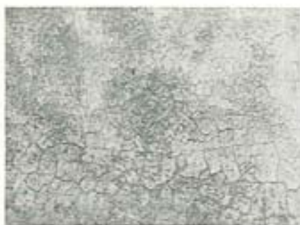
Fig. 13.14. Krakelering i pudslag med for meget bindemiddel.
