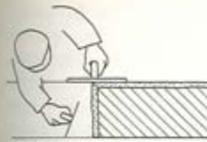
Fig. 9.16. Pudsning af udadgående hjørne.
