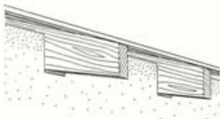
Fig. 9.35. Puds holdt frit af gennemgående spær.
